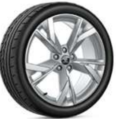
Draconis серебристые металлик, шлифованные 7.5J × 19" ET48 для 225/40 R19 5E3 071 499AN 8Z8
